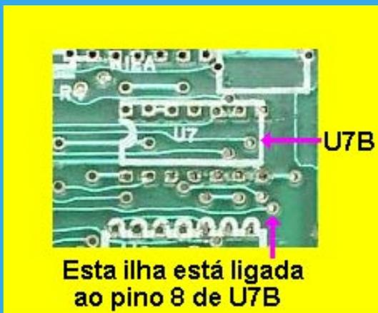
Figura 5: detalhe da placa da IDS91, mostrando-se o local de conexão de um jumper ligado ao pino 8 do 74LS20 (U7B).
